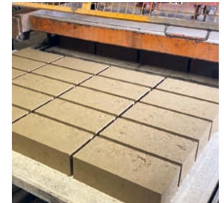
Die Lehmsteine Terrabloc M, die bei diesem Bauwerk eingesetzt wurden, sind mit rund vier Prozent Zement stabilisiert. Die Steine haben die Dimensionen von 29,5 cm Länge, 14 cm Breite und 9 cm Höhe. Die Fugen wurden zementgebunden mit rund 40 Prozent Lehmanteil ausgeführt.
